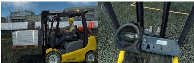
El simulador de Montacargas o Forklift permite situaciones de riesgo, reproduce accidentes, evalúa el nivel de cumplimiento de las normas de seguridad y realiza movimientos que no se pueda entrenar en una máquina real por razones de seguridad.
