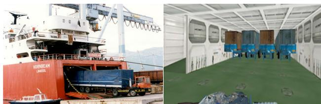
El Ro-Ro (Roll in/Roll off) es una cabeza tractora para la estiba y desestiba de plataforma de camión (remolques) en los ferrys. Es una máquina con una gran maniobrabilidad y potencia. El operario del RO-RO debe conocer bien la conducción de esta maquinaria para poder dejar la carga en posiciones del barco que en ocasiones resultan de gran dificultad.
