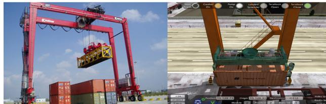
Herramienta clave para la manipulación de contenedores en el patio, yarda o tierra en una terminal portuaria. Es una grúa rígida montada sobre ruedas que permite el traslado de la carga en línea recta sobre un camino horizontal.
