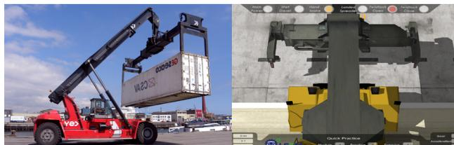
El sistema permite la simulación de distintos tipos de vehículo, como los reach-stackers. Este tipo de máquina es utilizado para distintas funciones en la operación normal de un terminal de contenedores, tales como el traslado de los mismos, y su puesta sobre remolques y camiones.
