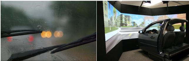
Los Simuladores e-Tech de automovil, son simuladores virtuales computarizados, de alta definicion multi-canal en formato de foro de proyección o monitores de alta definición (plasma / LCD) que incluyen modelos dinámicos vehiculares especificos controlados por software especializado y modulable a diferentes tipos de características.
